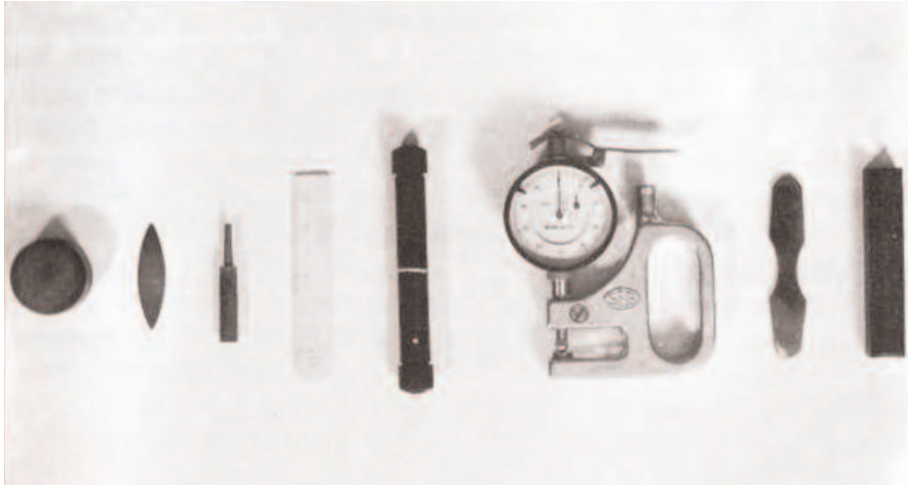
Da sinistra a destra: ceppo, linguetta, cannello, righello, cavalletto convesso, micrometro centesimale, raschietto, cavalletto concavo
