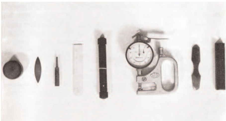
Da sinistra a destra: ceppo, linguetta, cannello, righello, cavalletto convesso, micrometro centesimale, raschietto, cavalletto concavo
